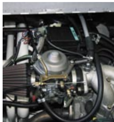
A versão em que voámos é toda construída em alumínio aeronáutico, tem motor Rotax de 100 cv
