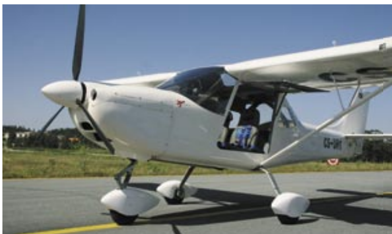
A versão em que voámos é toda construída em alumínio aeronáutico, tem motor Rotax de 100 cv
