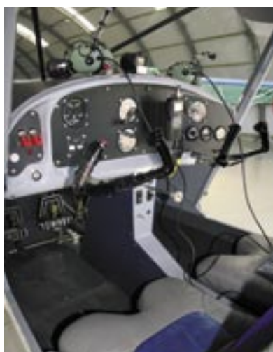
A versão em que voámos é toda construída em alumínio aeronáutico, tem motor Rotax de 100 cv
